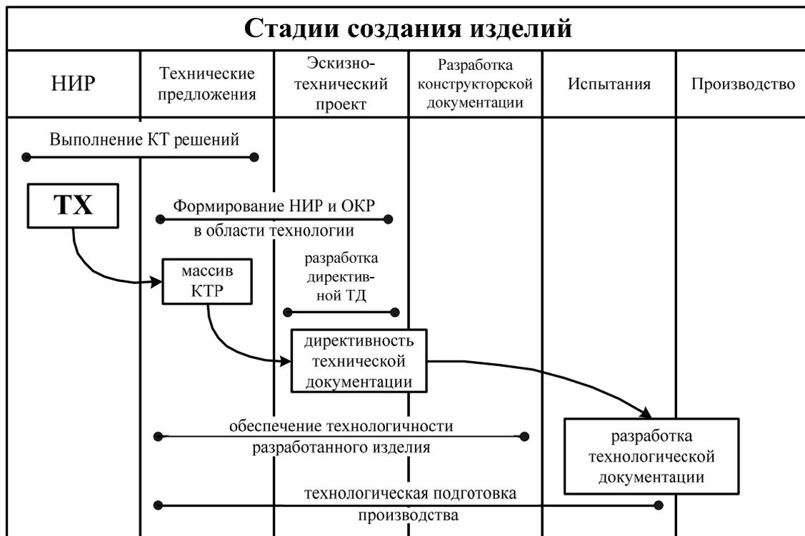
Рис. 11. Принципы технологического обеспечения производства
